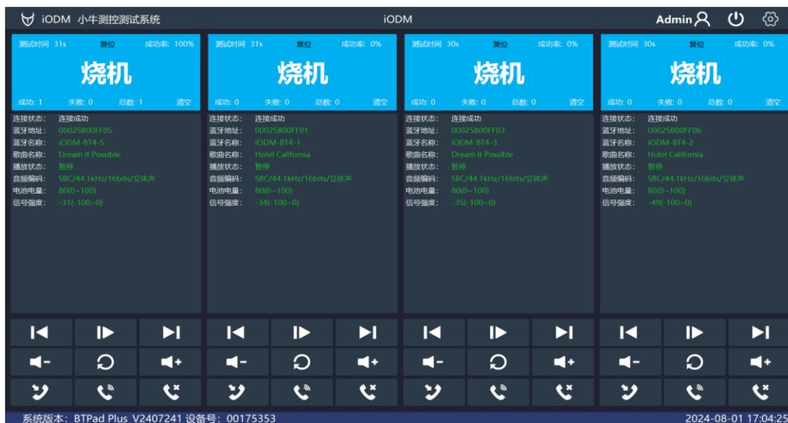
BTPad-Plus 一拖四智能蓝牙测试仪烧机模式自动记录续航测试过程的各种数据、放电曲线，老化结束后生成报表记录，过程无需人工跟进的监测系统。
